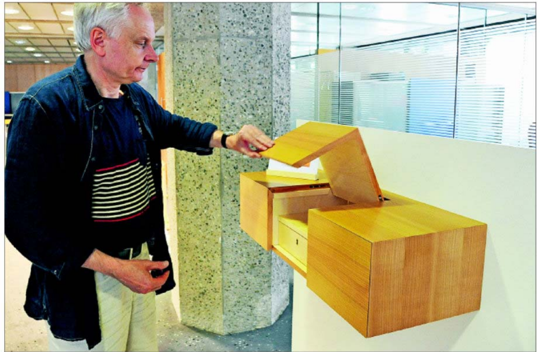
Prüfungsausschussmitglied Jörg Steinle und das Gesellenstück von Steffen Beck: Unter der Klappe kommt eine abschließbare Schublade zum Vorschein
